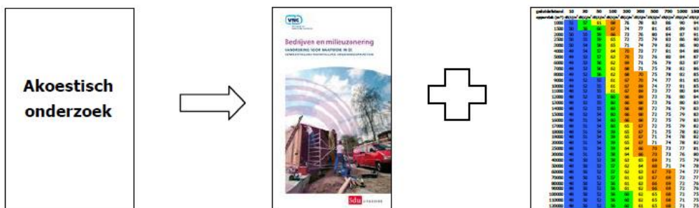
Figuur 3: schematisch overzicht - neem de geluidsproductie uit het akoestisch onderzoek – vergelijk die met de waarde volgens 'Bedrijven en milieuzonering' en de tabel.
